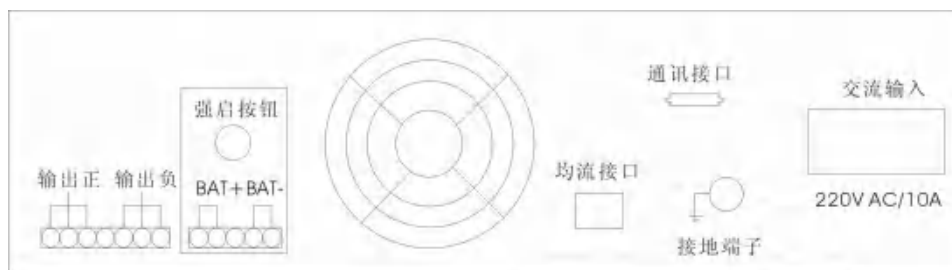
图 7 SOC-P4820/1000 电源箱背面板示意图
